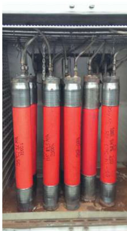
Рис. 5. Вид образцов напорной трубы КОРДФЛЕКС при испытании на стойкость к внутреннему давлению при температуре до 135 °С
