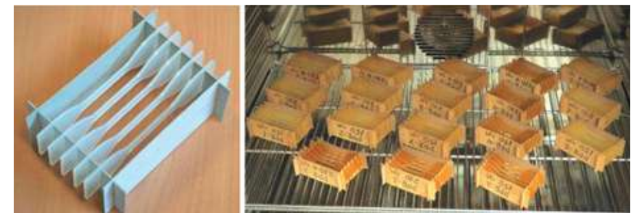
Рис. 4. Вид образцов материалов при испытании на старение при температуре 135 °С
