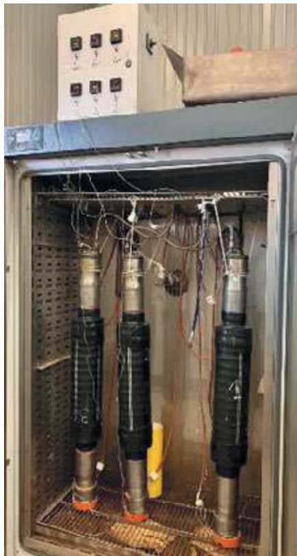
Рис. 5. Вид образцов напорной трубы КОРДФЛЕКС при испытании на стойкость к внутреннему давлению при температуре до 135 °С
