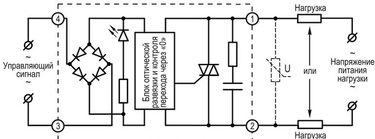
Рисунок 6 - схема подключения ТТП серий HD-xx44.ZA2 [M02]
