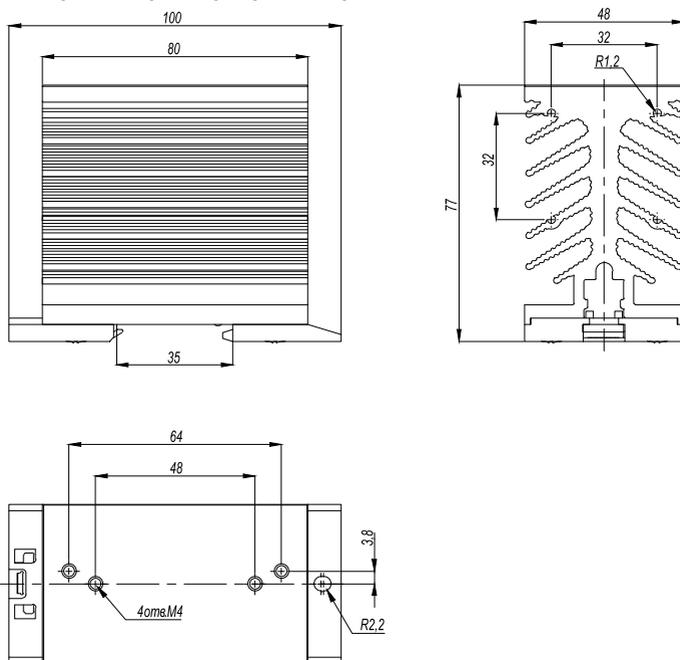
Рисунок 29 – габаритные и установочные размеры радиатора РТР052
