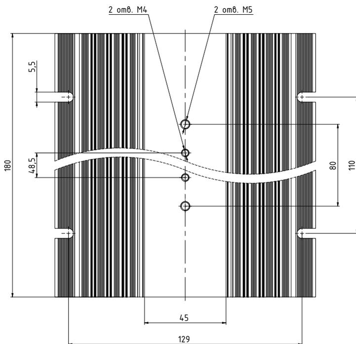
Рисунок 33 – габаритные и установочные размеры радиатора РТР063.1
