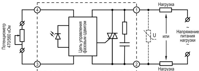
Рисунок 10 - схема подключения ТТР серии HD-xx44.VA [M02]
