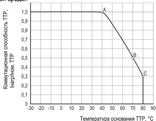
Рисунок 41 - зависимость тока реле от температуры основания ТТР
