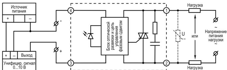
Рисунок 12 - схема подключения ТТР серии HD-xx422.10U [M02]
