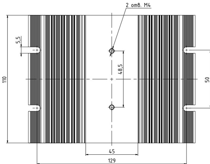
Рисунок 32 – габаритные и установочные размеры радиатора РТР062.1
