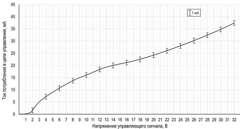
Рисунок 22- ВАХ входной цепи ТТР серии HD-xx25.DD3 [M02]
