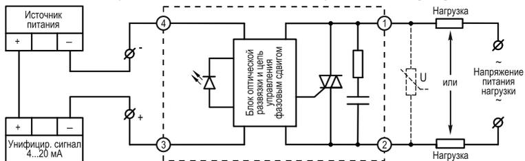
Рисунок 11 - схема подключения ТТР серии HD-xx44.LA [M02]
