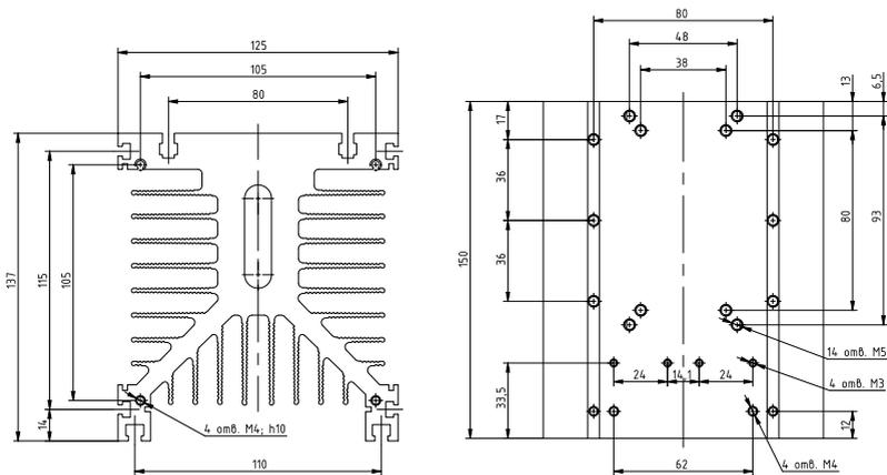
Рисунок 37 – габаритные и установочные размеры радиатора PTR038
