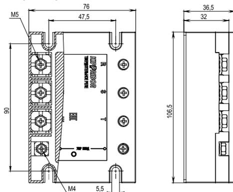
Рисунок 15 - габаритные и установочные размеры ТТП серий HT-xx44.ZD3, ZA2 [M02]
