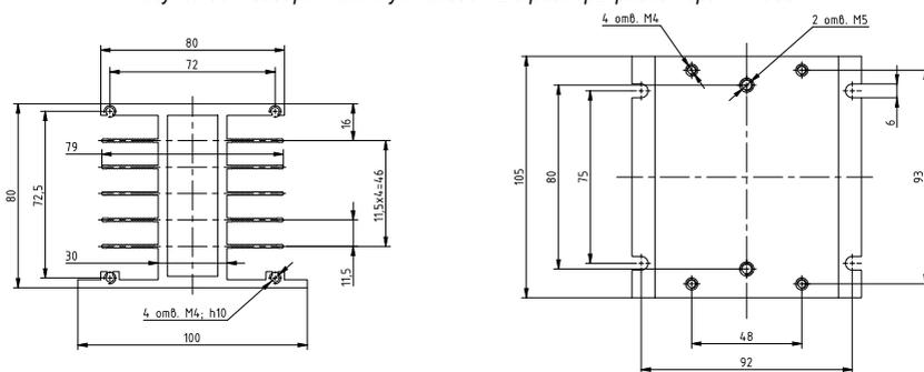
Рисунок 34 – габаритные и установочные размеры радиатора РТР034
