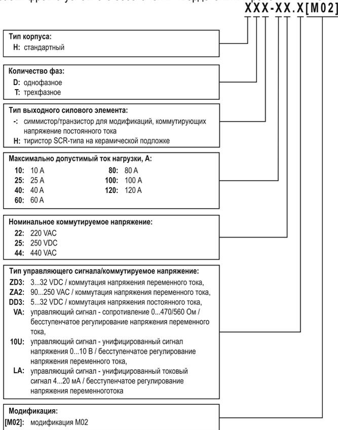
Рисунок 1 - расшифровка условного обозначения ТТР KIPPRIBOR модификации [M02].
