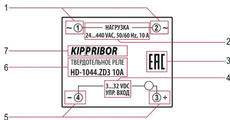
Рисунок 2 – заводская маркировка ТТР серий HD, HDH
