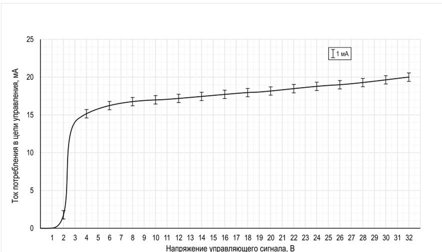
Рисунок 23 - ВАХ входной цепи ТТР серии НТ-хх44.ZD3 [M02]
