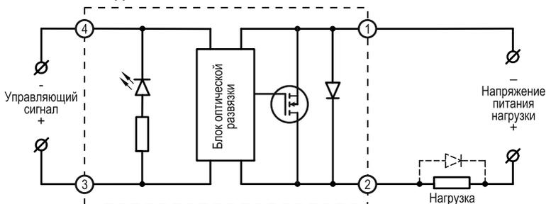
Рисунок 8 - схема подключения ТТП серии HD-xx25.DD3 [M02]
