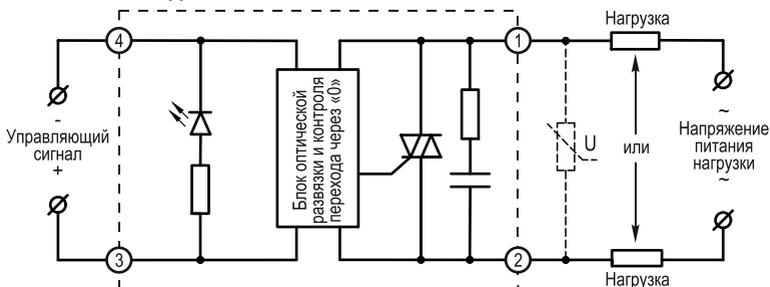
Рисунок 5 – схема подключения ТТП серий HD-xx44.ZD3 [M02]
