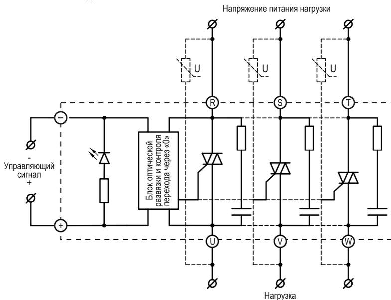
Рисунок 16 – схема подключения ТТП серий HT-xx44.ZD3 [M02] с силовыми ключами типа TRIAC
