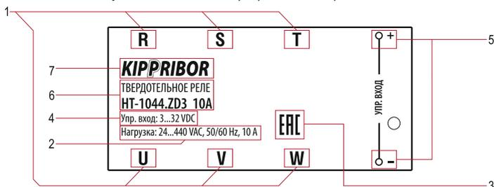
Рисунок 3 - заводская маркировка ТТР серий HT
