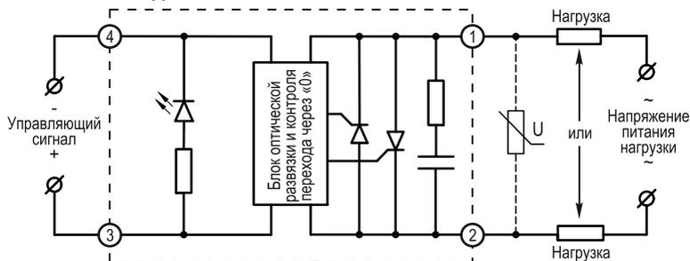
Рисунок 14 - схема подключения ТТР серии HDH-xx44.ZD3 [M02]
