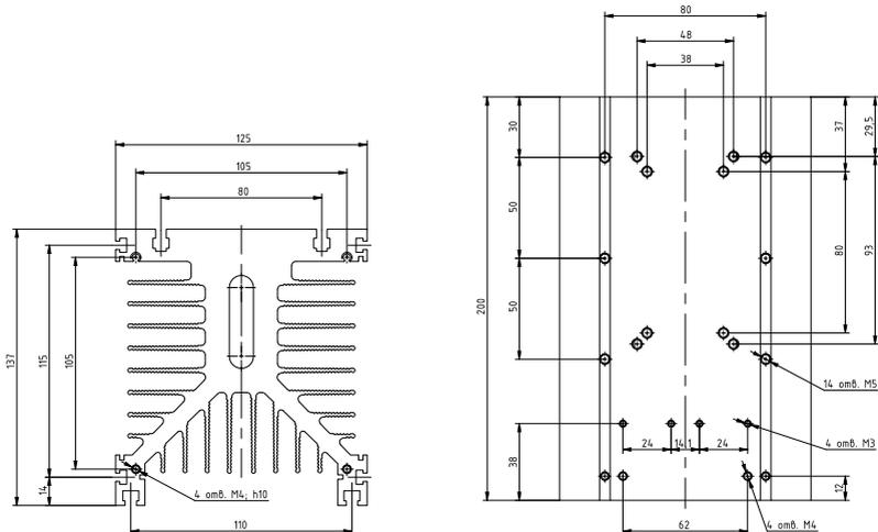
Рисунок 38 – габаритные и установочные размеры радиатора PTR039
