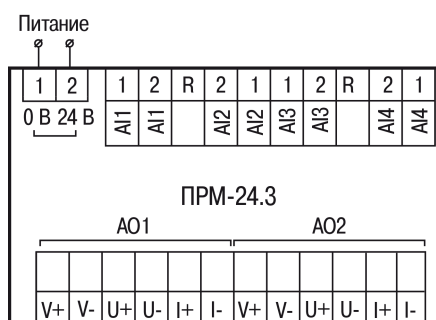
Рисунок 5.2 – Назначение контактов клеммника прибора с питанием 24 В
