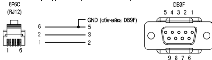
Рисунок В.4 – Кабель KC2 для подключения ПЛК154 к панелям ИП320, СП270 и СП3хх (порт RS-232 Debug)
