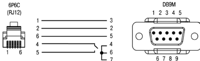
Рисунок В.2 - Схема кабеля КС3 для подключения модема к ПЛК154 по интерфейсу RS-232 Debug
