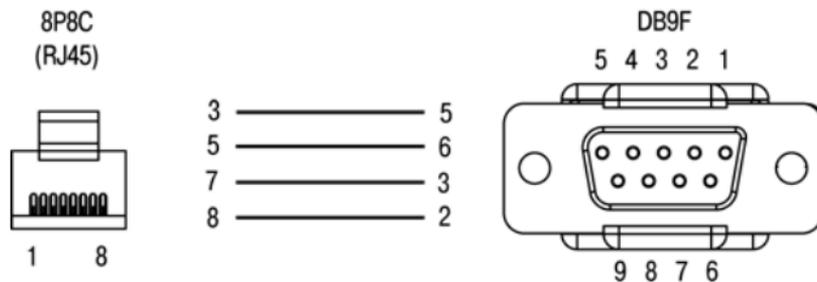
Рисунок Г.2 – Схема кабеля KC16
