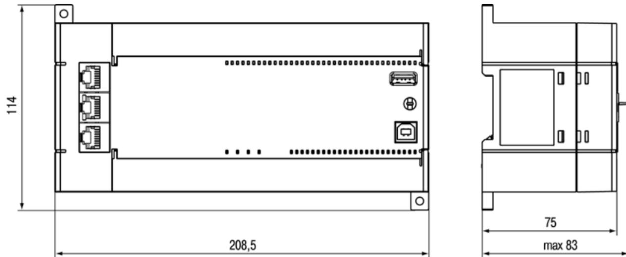
Рисунок А.1 – Габаритные размеры ПЛК110.X.60.X-X
