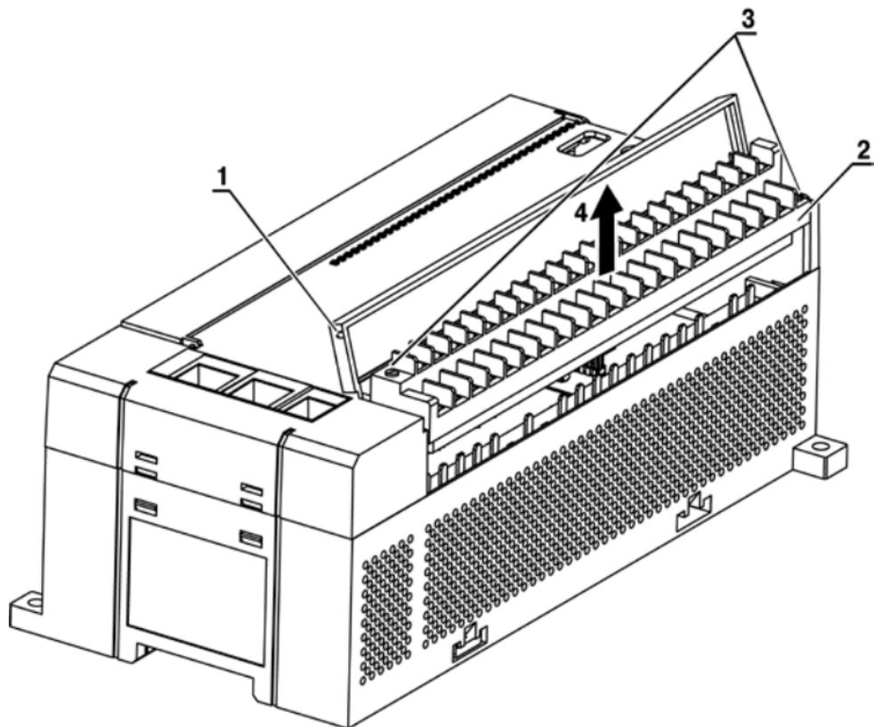
**Рисунок Д.1 – Отсоединение клеммных колодок контроллера**
