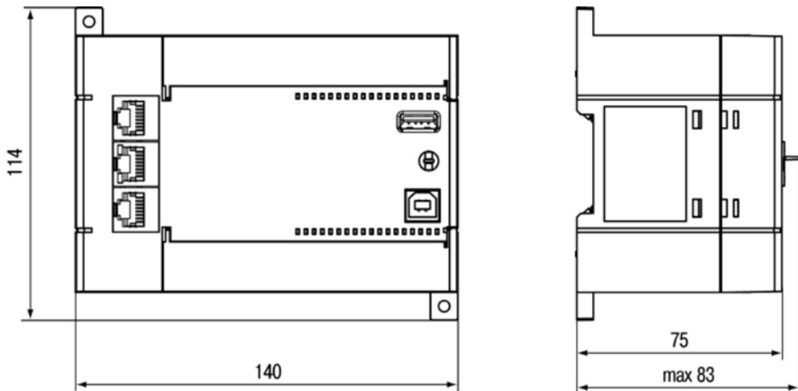
**Рисунок А.2 – Габаритные размеры ПЛК110.Х.32.Х-Х и ПЛК110.Х.30.Х-Х**
