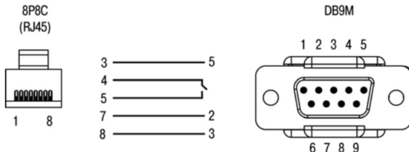
Рисунок Г.3 – Схема кабеля КС17 «ПЛК–Модем»
