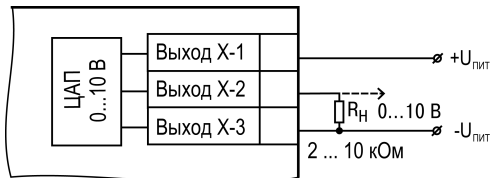
Рисунок 5.20 – Схема подключения нагрузки к ВУ типа У
