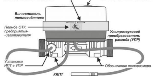
Рисунок 3 – Теплосчетчики KARAT-Компакт 2-223
