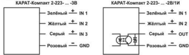
**Рисунок 5 – Принципиальная схема подключений импульсного входа/выхода**
