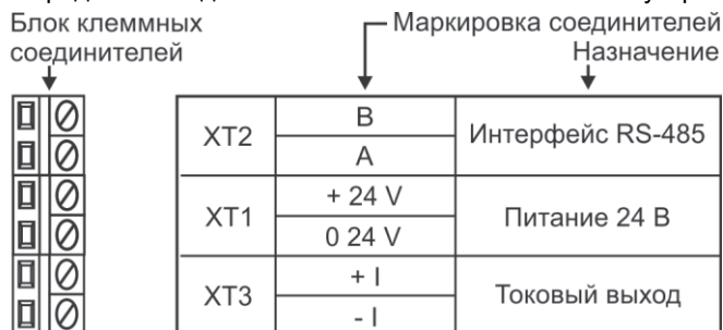
Рисунок 1.6 – Подключение внешних цепей к п/п ЖКИ и RS-485
