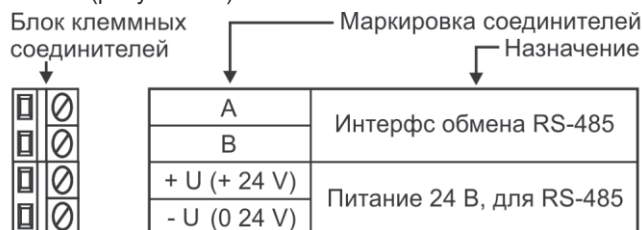
Рисунок 1.7 – Подключение внешних цепей к п/п RS-485
