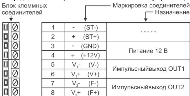
Рисунок 1.5 – Подключение внешних цепей к п/п ЭБ
