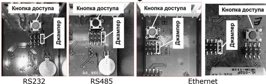
Рисунок 5.1 – Расположение кнопки доступа в зависимости от типа интерфейса
