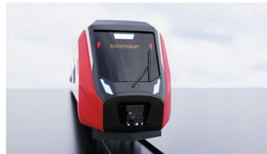
Проект поезда в четырехвагонном исполнении на постоянном токе Иллюстрация: пресс-центр Группы Синара
